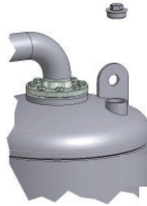
**Desmontar bloque de válvulas de retención**
